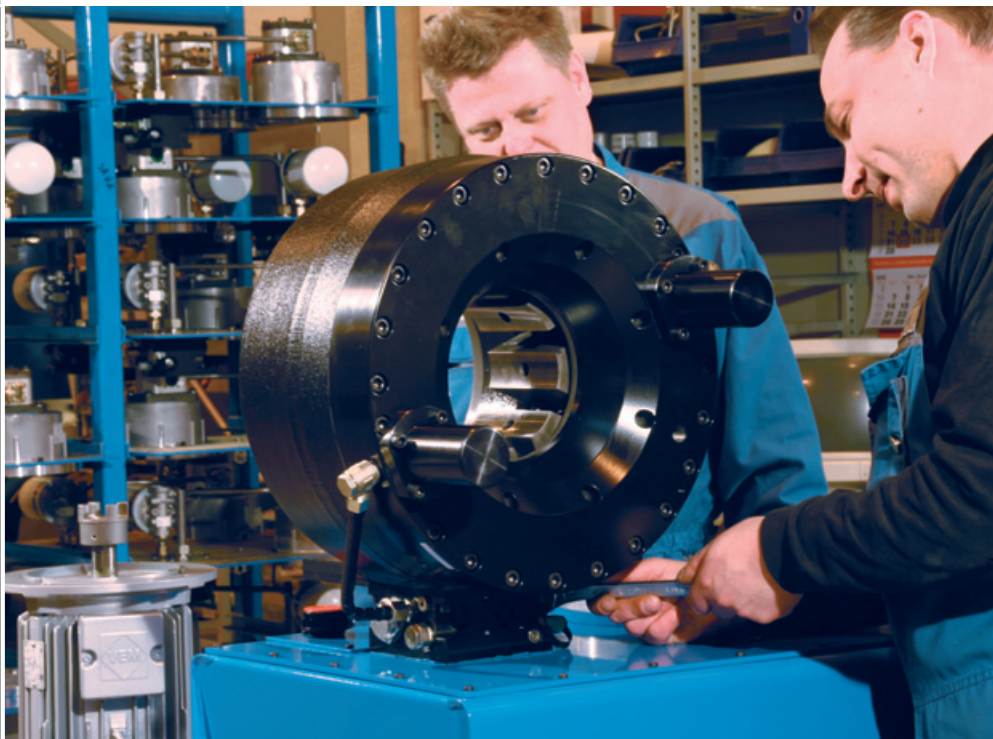
Станок P60. Большая обжимная головка и большое раскрытие кулачка для коленчатых деталей.
